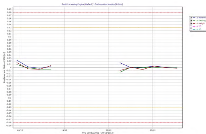
Figura 70: Línea base de comportamiento para la estación GNSS permanente de Estumo a diciembre de 2012.
